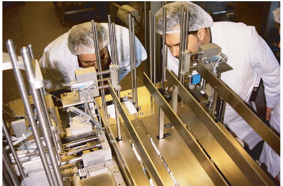
Endkontrolle und Einrichtung einer EME-Anlage vor der Auslieferung an den Kunden
